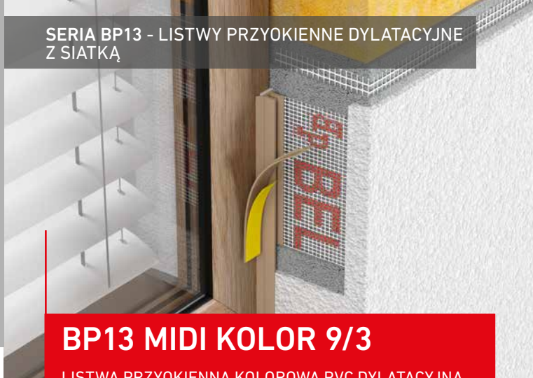
BP13 MIDI 9/3 LISTWA PRZYOKIENNA PVC DYLATACYJNA Z SIATKĄ I Z USZCZELKĄ 9mm (szerokość listwy) / 3mm (szerokość korytka)
